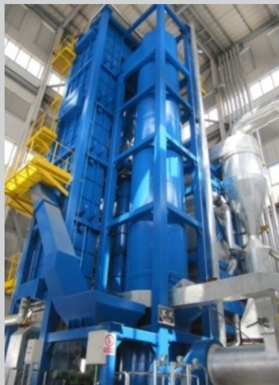
循环流化床一体化污泥焚烧炉
