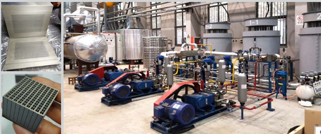
国内首座双回路全温全压超临界二氧化碳换热器综合测试平台
