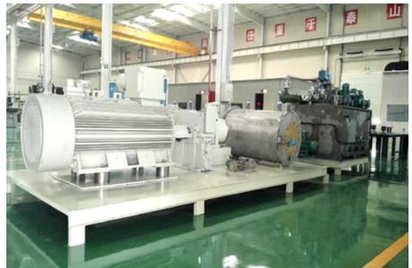
300kW 天然气余压发电系统样机
