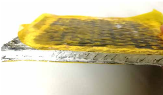
可太空固化的无机填充柔性材料
