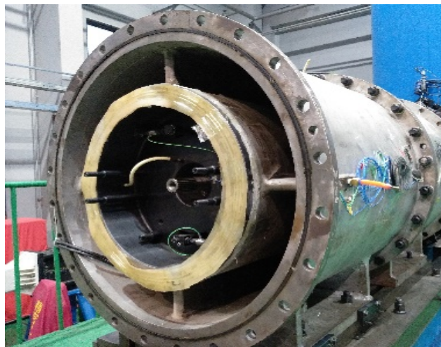
大负载高转速电磁涡流测功器
