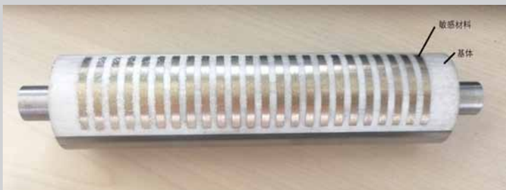
集成位移敏感传感器的作动轴样件
